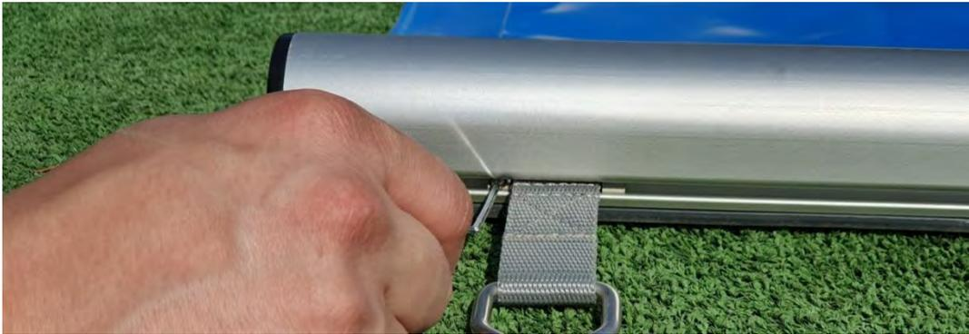
Das Bohren mit dem  $\varnothing$  10 mm Bohrer, im Abstand 100 mm von der Abdeckung.
