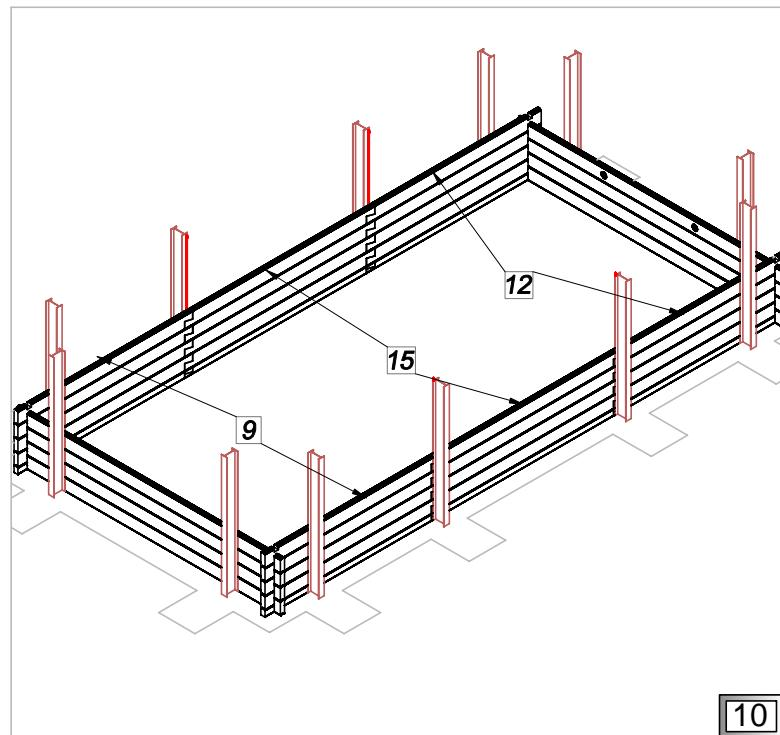
**PL** Proponowany układ deski z otworem na lampa, zalecane w przedziale 450 - 700 mm poniżej lustra wody
